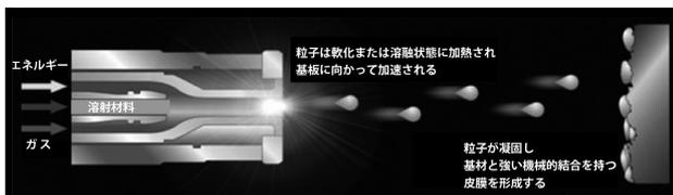
図2b 溶射皮膜形成の原理
